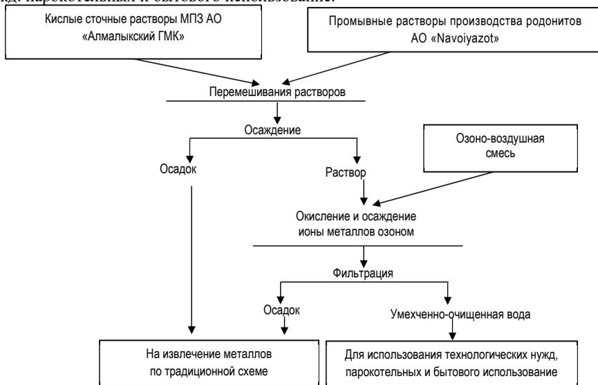
Рисунок 1. Рекомендуемая технологическая схема переработка сточных вод
