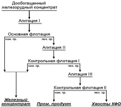
Рисунок 10. Принципиальная технологическая схема переработки дообогащенного железорудного концентрата
