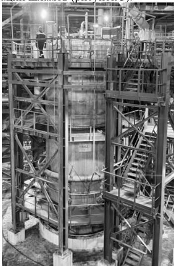
Рисунок 3. Колонная флотомашина
