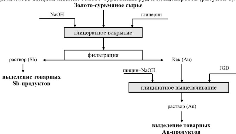
Рисунок 1. Принципиальная схема гидрометаллургической технологии комплексной переработки золото-сурьмяных руд и концентратов
