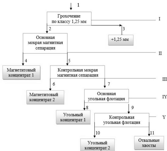
Рисунок. Схема переработки золошлаковых отходов Н-ИТЭС
