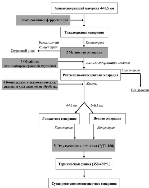
Рисунок 1. Схема исследований последовательности применения методов интенсификации процессов глубокого обогащения алмазосодержащего материала
