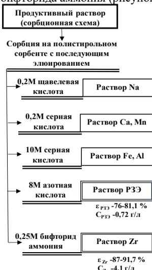
Рисунок. Сорбционная схема извлечения РЗЭ из продуктивного раствора кислотного выщелачивания эвдиалита
