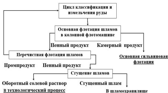
Рисунок 4. Усовершенствованная схема обесшламливания руды
